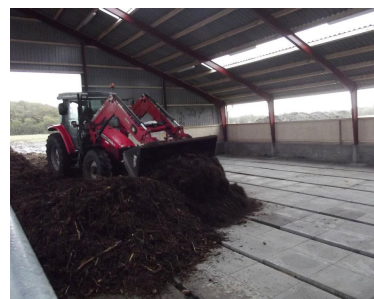
Her køres den første flis ind på gulvet med indbygget beluftning.
